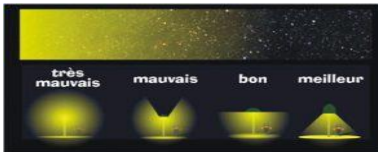
Schéma de l'adaptation des dispositifs d'éclairage pour les chauves-souris (source : région Occitanie).
